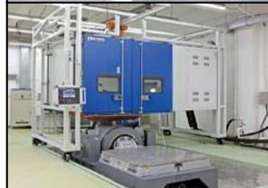
振動/機械衝撃実験室:2室
